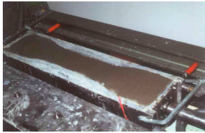
Abb. 3.8.: Möglichkeiten experimenteller Untersuchung erhärtungsbedingter Zwangsspannungen; links: Belastungsrahmen MPA Braunschweig [mpa.tu bs.de (2012)]; rechts: Restrained Ring Test [cement.org (2012)]
