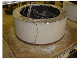
Abb. 3.8.: Möglichkeiten experimenteller Untersuchung erhärtungsbedingter Zwangsspannungen; links: Belastungsrahmen MPA Braunschweig [mpa.tu bs.de (2012)]; rechts: Restrained Ring Test [cement.org (2012)]
