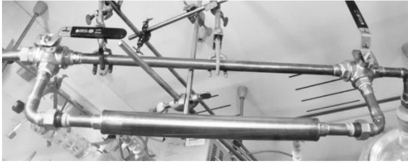
Abb. 5: Die Löffler-Gabel: Optionaler Wechsel von herkömmlichem Geistrohr zu trenneffizienterer Kupferpackungskolonne zur Methanolabtrennung im Vorlauf
