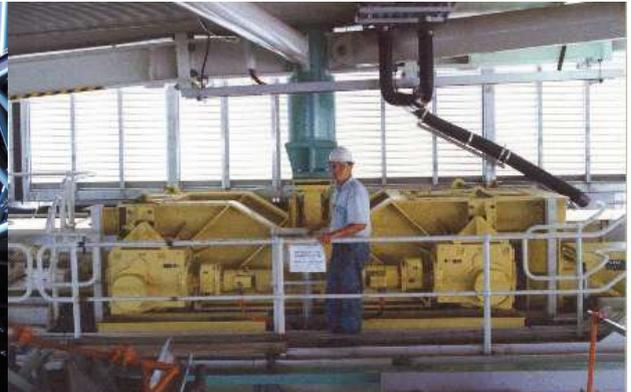
Abbildung 5-90: ein Rollenwagen des beweglichen Daches
