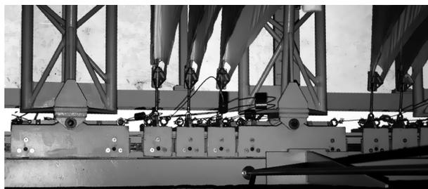
Abbildung 5-94: Laufwagen des geöffneten Daches von unten
