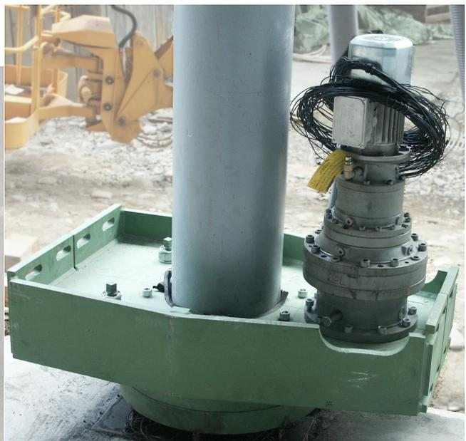
Abbildung 5-56: Lager des Drehtores mit montiertem Getriebemotor
