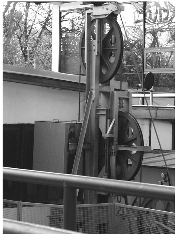
Abbildung 5-136: Antrieb mit Spanneinrichtung
