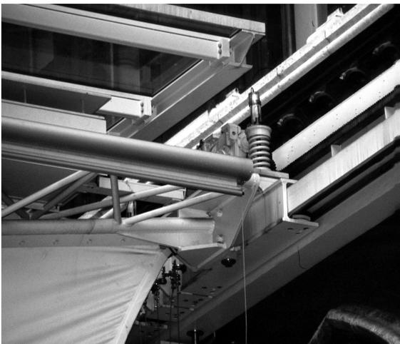
Abbildung 5-93: Endquerträger mit Laufwagen, Laufrad, Antriebsritzel und Zahnstange
