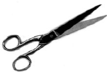
Als Gerät werden jene Gelenksketten bezeichnet, die nicht fix gelagert sind. Als einfaches Beispiel sind Scheren zu nennen, zwei Elemente welche eine offene nicht gelagerte Gelenkskette bilden (Abbildung 3-4).
