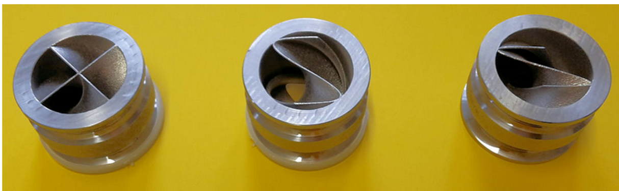
Abbildung 2: Drallerzeuger aus Inconel 718 mit Additive Manufacturing hergestellt
