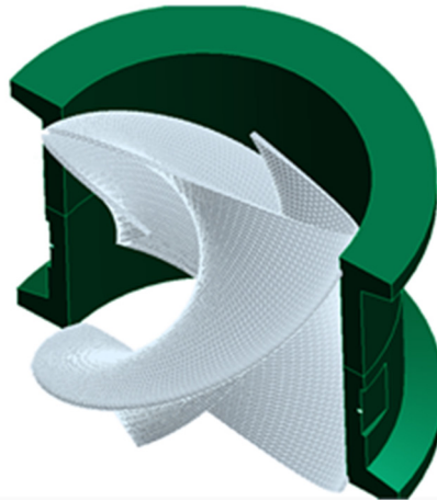
Abbildung 1: 3D Konzept für den Drallerzeuger
