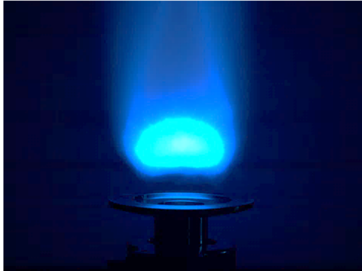
Abbildung 3: Drallstabilisierte, vorgemischte Flamme
