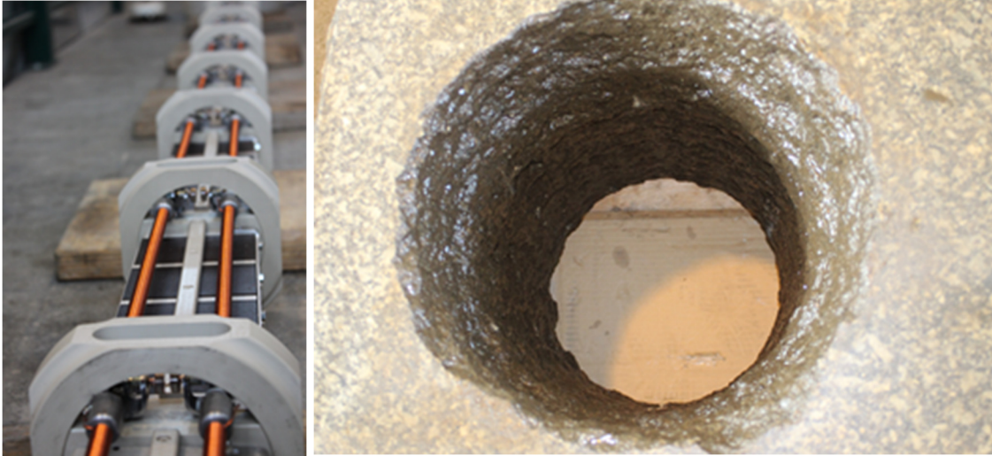
Abbildung 3: Impulsspannungsgenerator und 12 ¼“ Bohrloch in Granit im Labor
