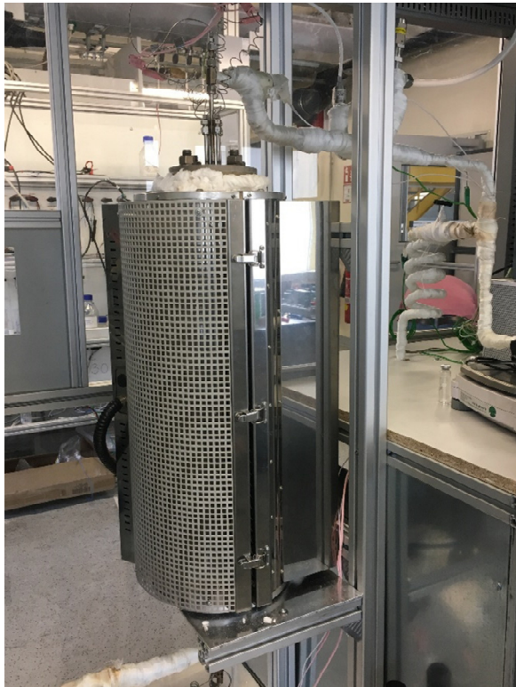
Abb. 1: Ethanol-Reformer im Brennstoffzellen-Labor des Instituts für Chemische Verfahrenstechnik und Umwelttechnologie.
