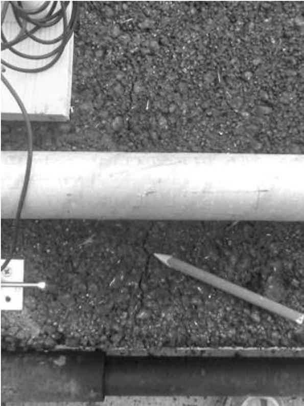
*Abbildung 69 Riss 1 – Rissweite ~1 mm*
