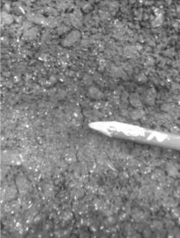
Abbildung 72 Riss 4 – Rissweite ~0,3 mm
