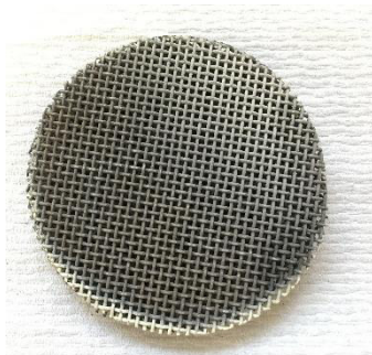
Abb. 2: Katalysator für die Ethanol-Dampfreformierung auf metallischem Trägermaterial.
