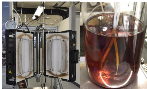
Abb. 1: links: Reaktor mit Heizmantel; rechts: Feed für HDO 2
