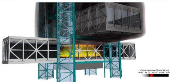
Abbildung 8: Brandsimulation eines Nutzungseinheit in einer Turmstruktur auf Basis eines BIM-Modells
