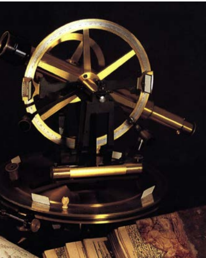
Abb. 6.2: Triangulierungstheodolit mit Repetitionseinrichtung. Instrumente dieser Genauigkeit dienten den Brüdern Schlagint- weit bei ihren Messaufgaben im Gebirge (Archiv TU Graz).
