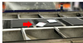
Abbildung 2 Typische Betriebsprobleme bei der automatisierten Verarbeitung von Polybags: Probleme innerhalb der Einschleusung auf dem Quersortierer aufgrund des geringen Sendungsgewichtes
