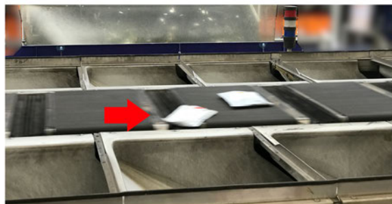
Abbildung 2. Typische Betriebsprobleme bei der automatisierten Verarbeitung von Polybags: Probleme innerhalb der Einschleusung auf dem Quergurtsorter aufgrund des geringen Sendungsgewichtes
