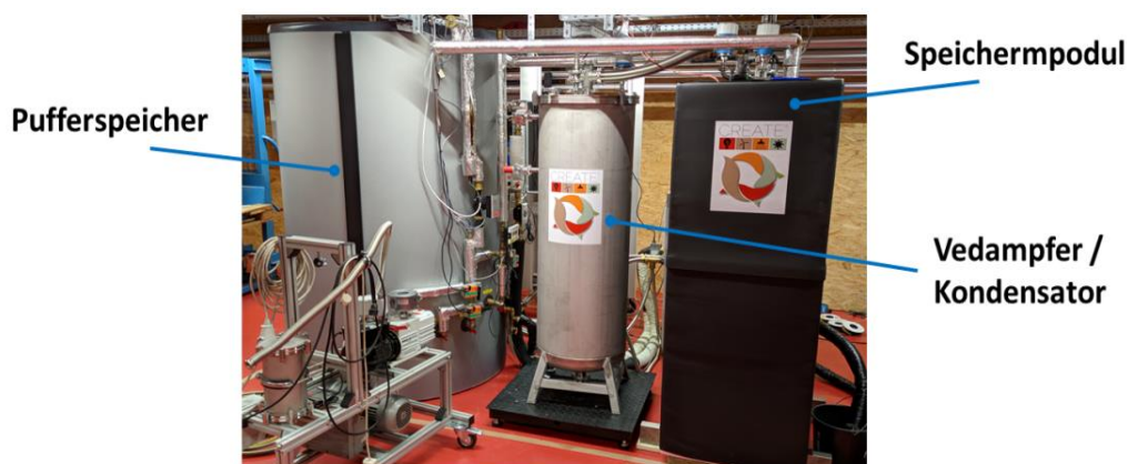
Abbildung 1: Aufbau des saisonalen thermochemischen Solarspeichersystems im Labor
