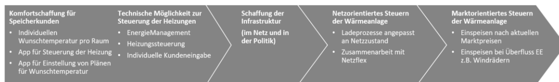
Abbildung 2: Use Cases der Wärmespeicher-Heizung
