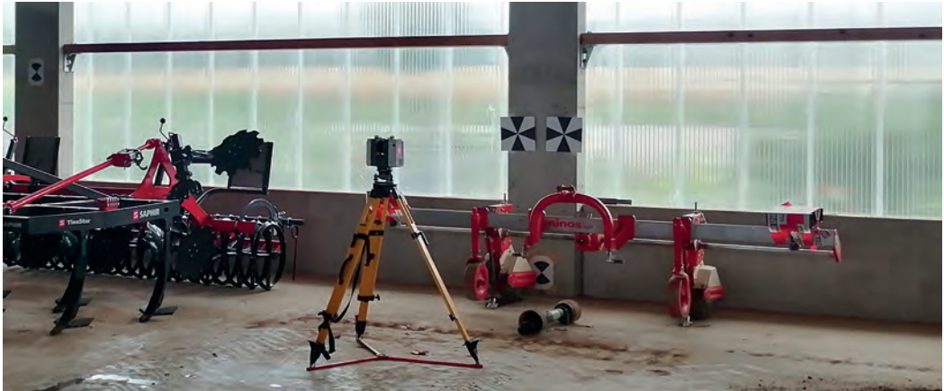
▲ Abbildung 42: Terrestrischer Laserscanner auf Stativ mit Zielmarken 113
