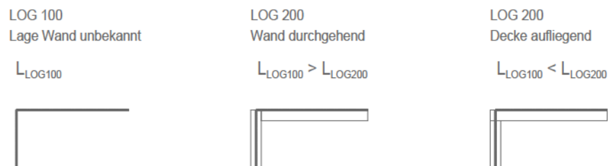
Bild 4-7: Längenänderung der Deckenelemente infolge dreidimensionaler Modellierung der tragenden Innenwand 191
