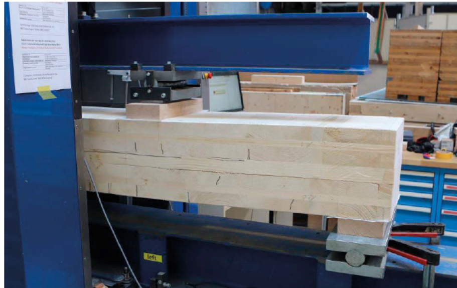
Bild 6-26: Prüfkörper P14 (Schub Leimfuge)
