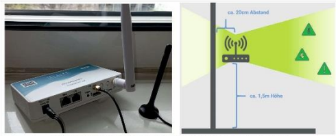
Abbildung 2: Rückseite des Sensors sowie die Verbindungen mit den Antennen (links) und die richtige Positionierung des Gateways für maximale Reichweite (rechts) [3].
