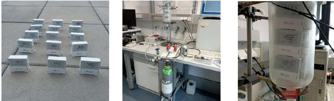
Abbildung 3-5. Zweistufiger Sensorkalibrierungsprozess, der die anfängliche Kalibrierung in der Außenumgebung (links) zeigt, gefolgt von einer Laborkalibrierung unter Verwendung von Referenzgasgemischen (Mitte) in einer versiegelten Kammer (rechts), um individuelle Kalibrierungskurven abzuleiten.
