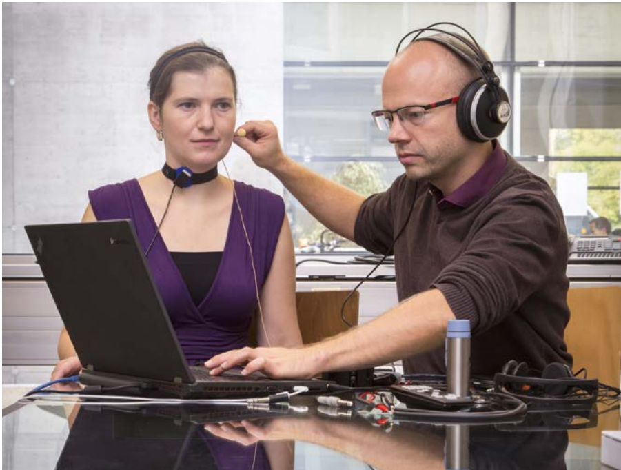
M. Hagmüller und A. Fuchs beim Experimentieren mit der Bionic Voice für kehlkopflose Patient*innen.
