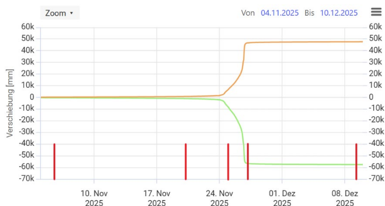
Abb. 2: Weg-Zeit-Diagramm des permanenten GNSS-Rovers im Bereich «Plateau Ost» im Zeitraum 04.11.2025 bis 10.12.2025. Orange: horizontale Verschiebung, grün: vertikale Verschiebung. Durchgeführte Drohnenflüge sind auf der Zeitachse rot markiert.
