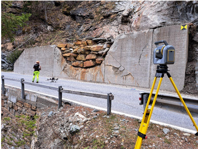
Abb. 10: Totalstation, Vermessungsdrohne und Spezialtarget zur Überwachung des Felssturzes Starlera im Averstal.
