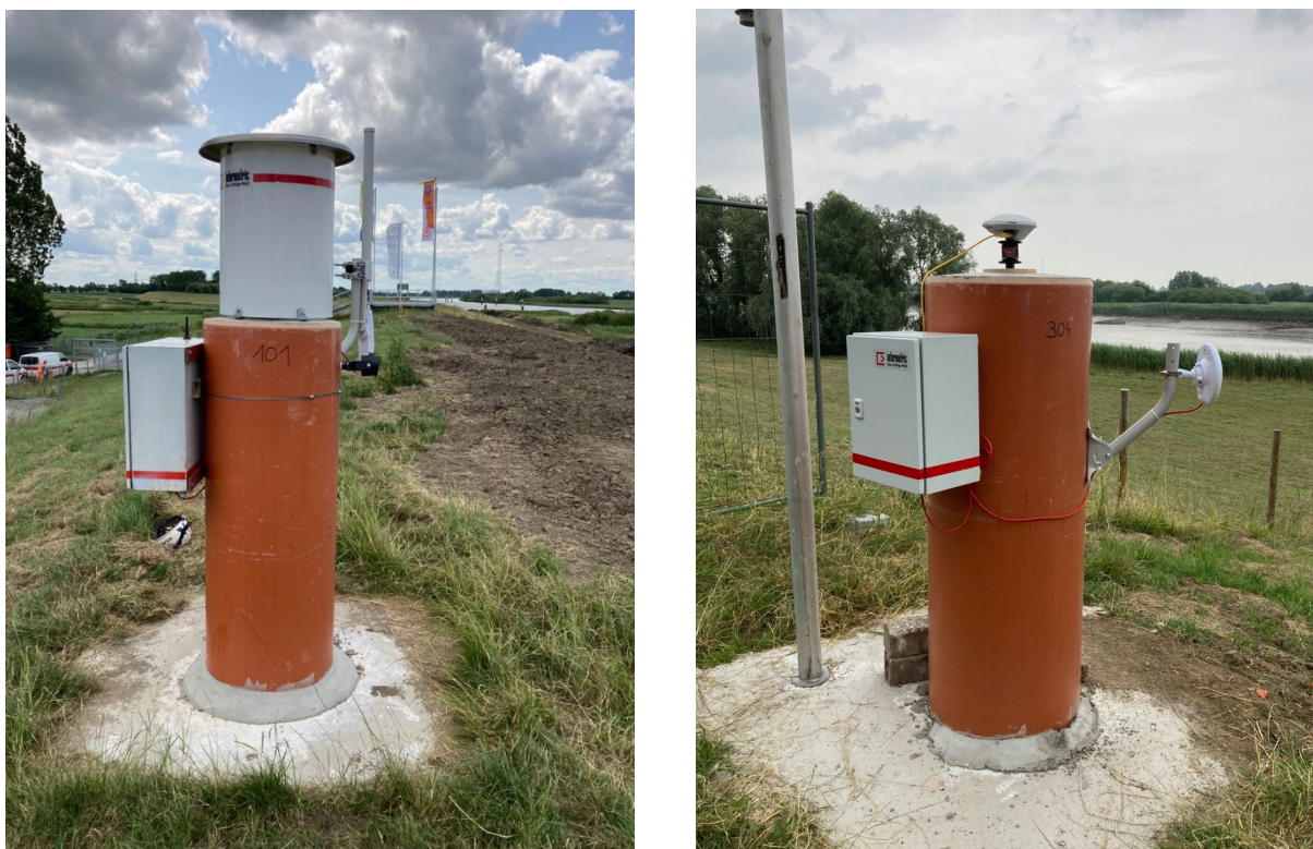
Abb. 6: Dynamisches Festpunktfeld; GNSS-, Tachymeterfestpunkt
