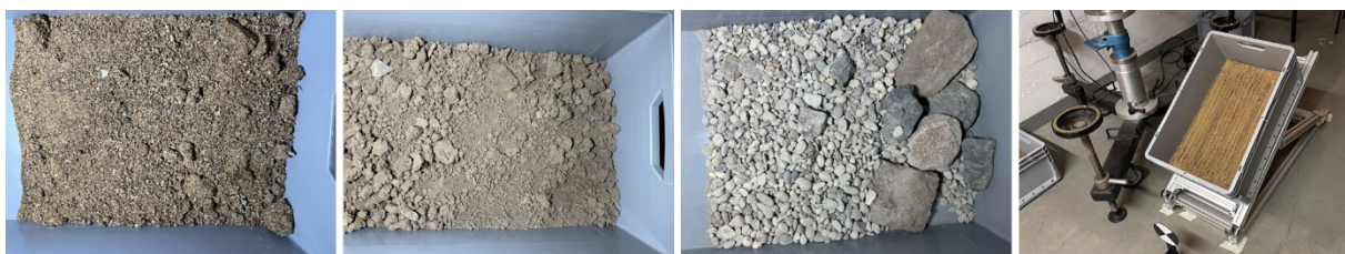
Abb. 2: Ausgewählte Bodenproben. V.l.n.r. feinkörnige Probe, mittelkörnige Probe grobkörnige Probe, Realisierung eines möglichst orthogonalen Auftreffwinkels (Fotos: Werny, Rabold).
