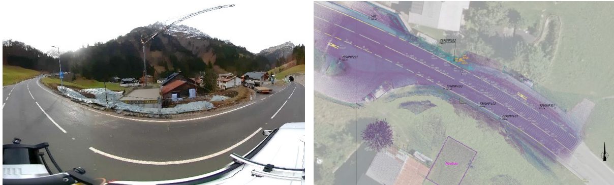
Abb. 8: Zustandserfassung mittels Panoramakamera (links) und Orthofoto und Punktwolke des Straßenbereichs mit Neubau (rechts)
