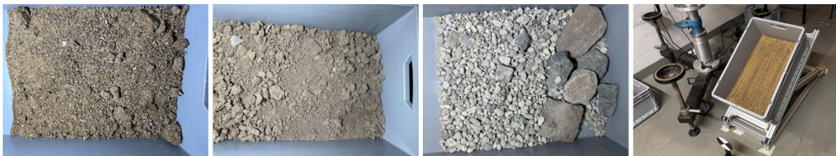
Abb. 2: Ausgewählte Bodenproben. V.l.n.r. feinkörnige Probe, mittelkörnige Probe grobkörnige Probe, Realisierung eines möglichst orthogonalen Auftreffwinkels (Fotos: Werny, Rabold).
