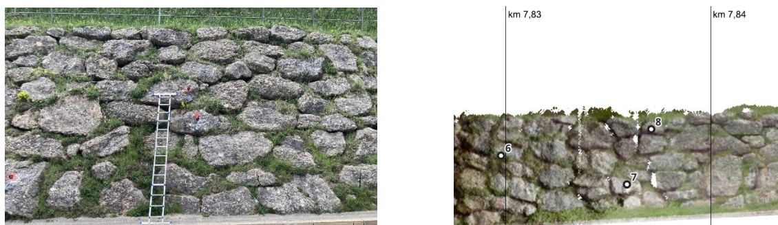
Abb. 7: Foto der Vermarkung diskreter Einzelpunkte für die tachymetrische Aufnahme (links) und vollflächige Information der abgewickelten RGB-Punktwolke (rechts).
