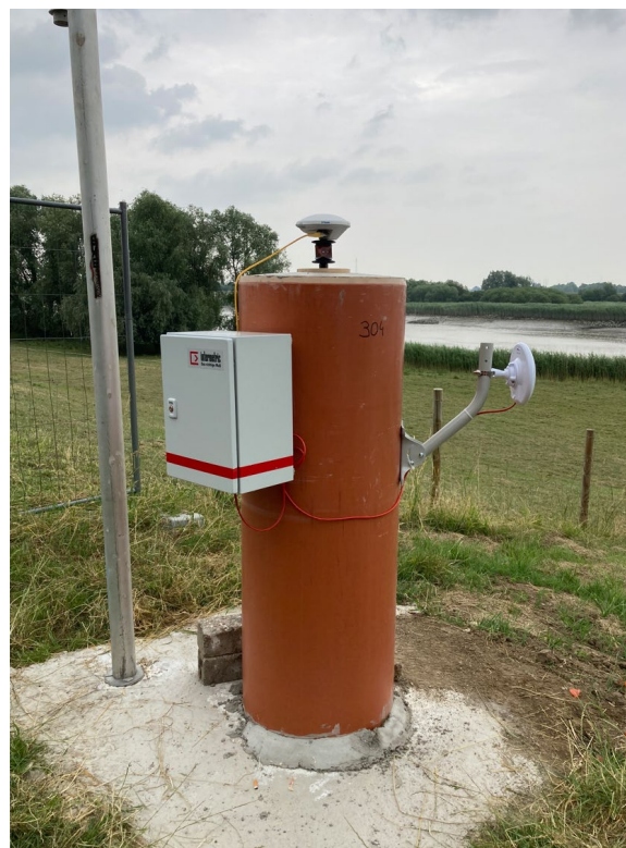
Abb. 6: Dynamisches Festpunktfeld; GNSS-, Tachymeterfestpunkt
