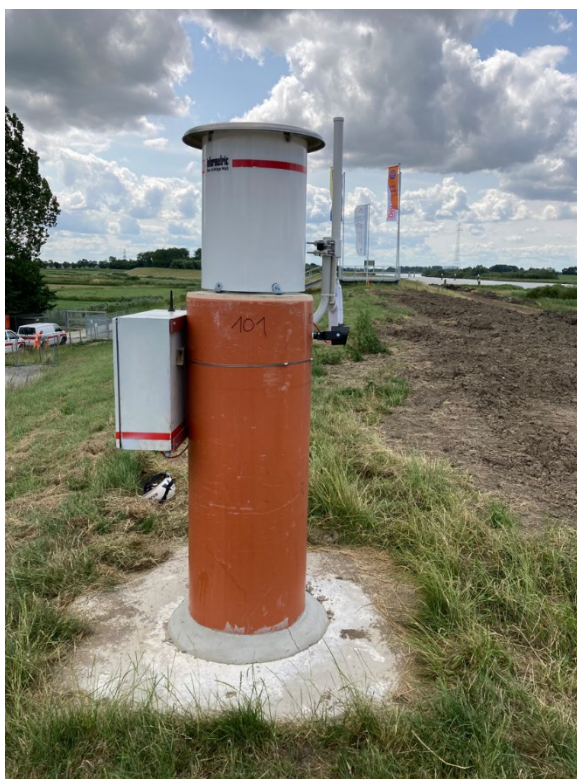
Abb. 6: Dynamisches Festpunktfeld; GNSS-, Tachymeterfestpunkt
