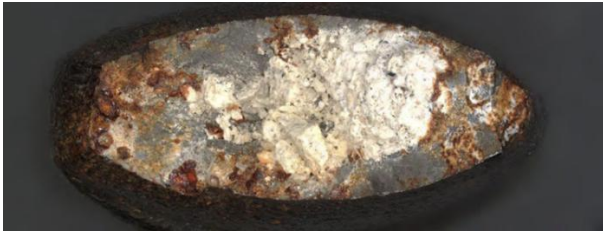
Abbildung 3 Bruchfläche eines Einzeldrahtes mit Mörtelanhaftung [3]
