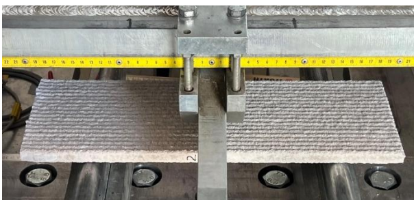
Abbildung 6 Überprüfung der Biegezugfestigkeit mittels Dreipunktbiegezugprüfung
