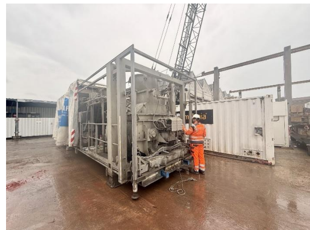
Abbildung 5 Mobile UHFB – Mischanlage der Implenia
