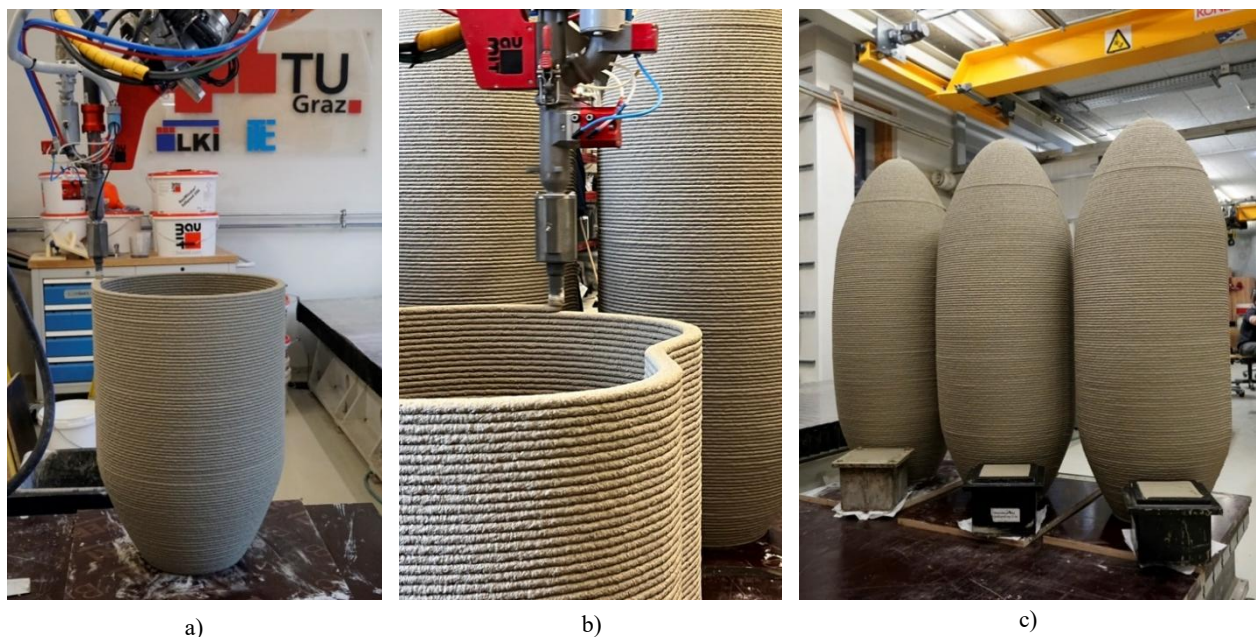
Abbildung 4 Darstellung des 3D-Druckverfahrens für die Aussparungskörper a) der statisch optimierten Variante V-06, b) der ökologisch optimierten Variante V-04, c) drei Aussparungskörper sowie Prüfkörper
