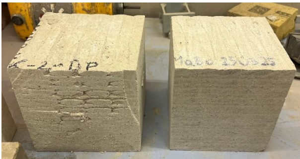
Abbildung 5 Überprüfung der Druckfestigkeit mittels Würfeldruckprüfung
