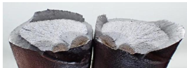
Abbildung 4 Halbelliptische Anrisslinsen in einer Bruchfläche eines Spannstahls nach Zugversuch Quelle: MFPA Weimar
