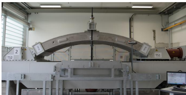
Abbildung 3 Tübbingprüfstand der Montanuniversität
