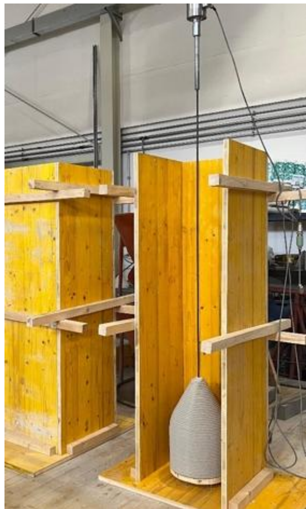
Abbildung 7 Versuchsaufbau zur Ermittlung der viskosen Widerstandskräfte
