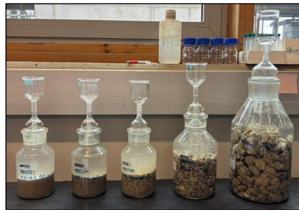
Abbildung 5 Bestimmung der Wasseraufnahme von Recyclinggesteinskörnungen in diversen Fraktionen vom feinen Sand bis zum groben Gesteinskörnungen
