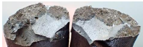
Abbildung 7 Maximal geschädigter Einzeldraht aus den Stützbereichen der Brücke 1.
